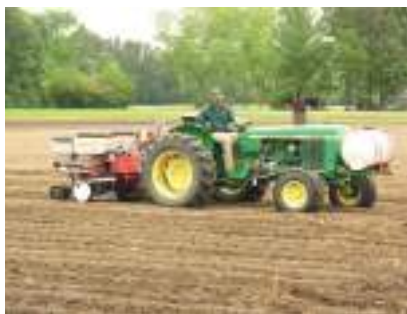
10-расм. Пневматик сеялкада ерёнғоқ экиш жараёни
