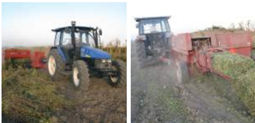
32-33-расмлар. Ерёғоқ дуқаклари поядан ажратиб олингандан сўнг, пояларни замонавий МХ-80 тракторига тиркалган CASE-III агрегати ёрдамида пресслаш жараёни
