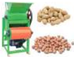
34-расм.Ерёнғоқни чақиш (декортикатор) машинаси (Хитой)
