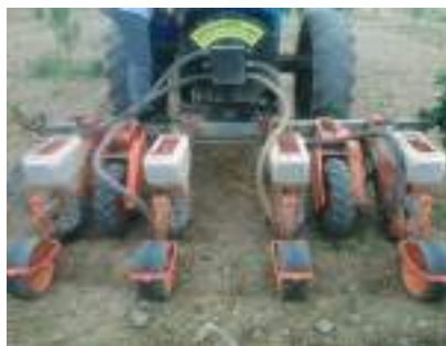
11-расм. Туркияда ишлаб чиқилган сеялка ёрдамида бог қатор ораларига ерёнғоқ экиш жараёни
