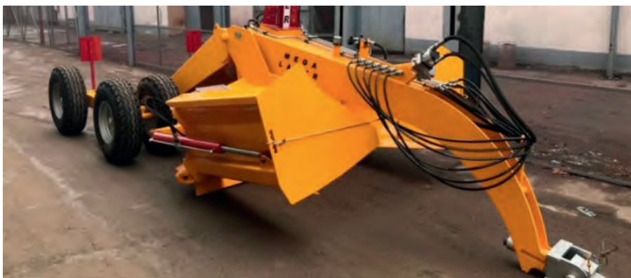
10- расм. Шолини экиш олдида ерларни лазерли текислаш
