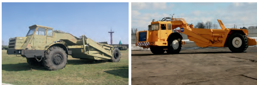
18-расм. Ер текислашда ишлатиладиган ўзиюар скреперлар
