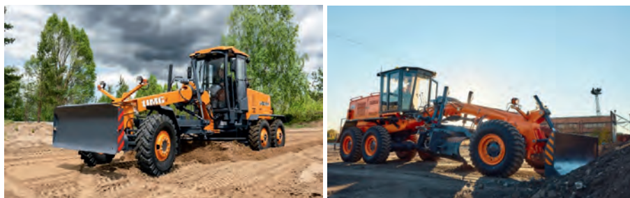
20-расм. Ер текислашда ишлатиладиган автогрейдерлар
