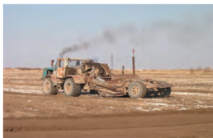
5-а). Гидротиркамали скреперда ерларни текислаш жараёни
