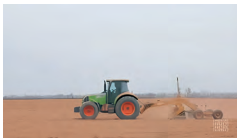
5-б). Лазер ускунаси билан жиҳозланган қисқа базали ер текислагич ёрдамида ерларни текислаш жараёни
