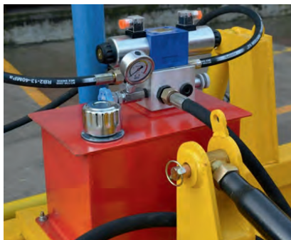
28-расм. Электрогидроклапан (соленоид гидроклапан)
