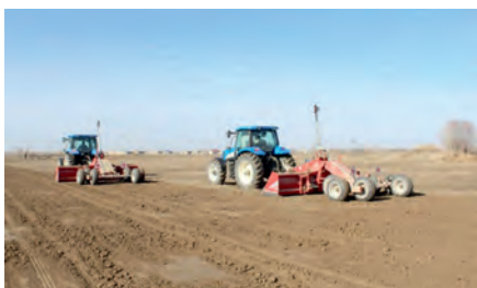
8-а). Лазер ускунаси билан жиҳозланган ер текислагичларда текислаш ишларини гуруҳ бўлиб амалга ошириш жараёни
