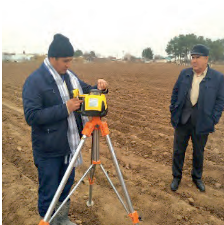
31-а). Топографик тасвирга олиш учун штативга (уч оёққа) транзиттерни ўрнатиш жараёни
