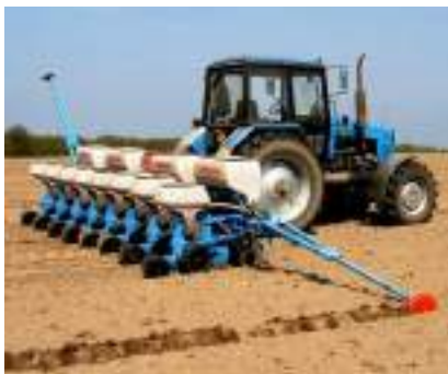
Замонавий уялаб экувчи сеялкаларда маккажўхори уруғини экиш жараёнлари
